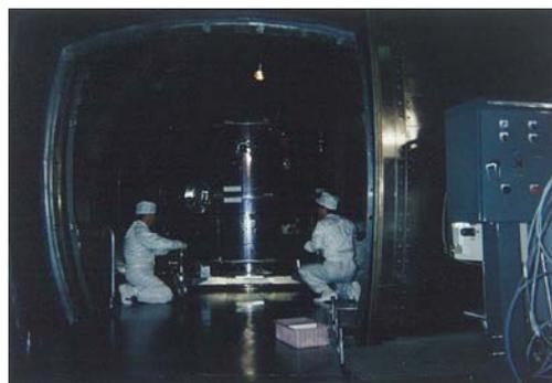
写真 1. 宇宙研の磁気シールドルームに納められた Geotail 衛星
